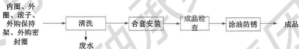
图 2-5 轴承装配生产工艺流程及产污节点图
